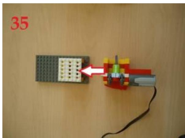
9. Подсоединяем мотор и устанавливаем датчик наклона:
